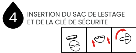
Insérer la clé de sécurité dans la fente et faire un quart de tour. La poubelle ne se replie plus.
